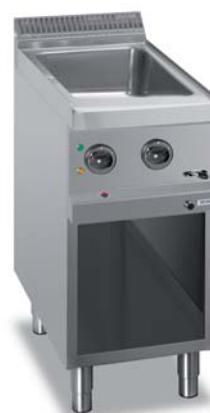
La gamma di bagnomaria SERIE 77 si compone di due modelli elettrici. Modularità: 40. Piano di lavoro è in acciaio AISI 304 e spessore di 1 mm. Vasca in acciaio AISI 304, stampata e saldata al piano in modo continuo. Capacità bacinelle GN 1/1. Riscaldamento elettrico con resistenza corazzata esterna alla vasca, fissate sul fondo esterno della vasca e controllate tramite termostato.
