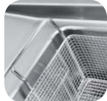
Una linea di friggitrici con vasche in acciaio inox AISI 304 18/10 con fondo vasca stampato, fissaggio al piano in modo continuo con saldatura robotizzata, sistema di scarico olio a fine servizio semplice e sicuro con vasca raccogli-olio con filtro in acciaio inox. Sono disponibili versioni ad una o due vasche, con riscaldamento a gas od elettrico, con bruciatori in vasca, con controllo temperatura elettromeccanico; versione top e monoblocco.
