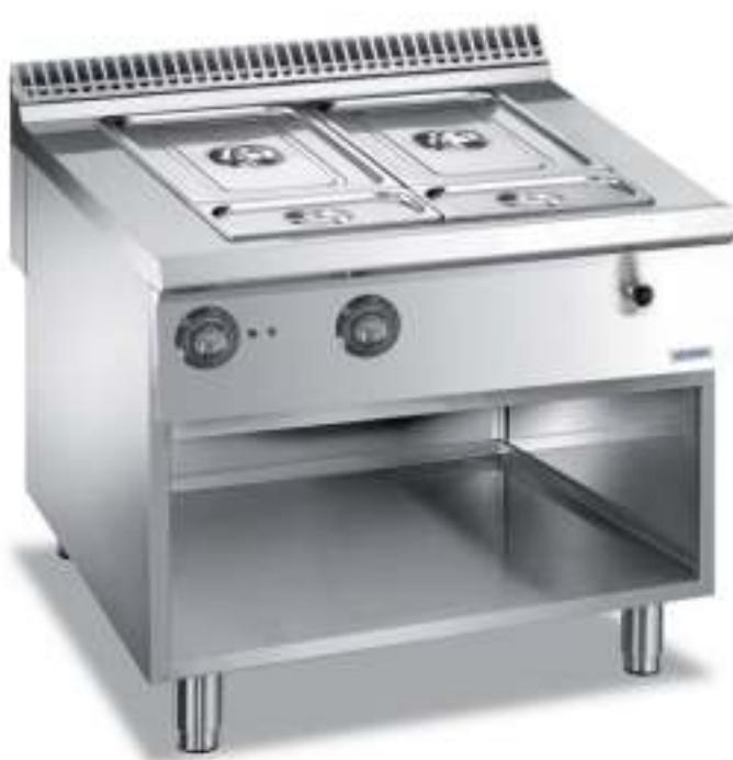
La linea è composta da 2 modelli con riscaldamento elettrico. La vasca è saldata al piano in modo continuo. Capacità bacinelle Gastronorm 4/3 per modulo 40 ed 8/3 per modulo 80. Il riscaldamento è elettrico, indiretto, fissato sul fondo esterno della vasca e controllato termostaticamente.
