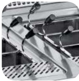
I cuocipasta **LUX 980** sono disponibili nelle versioni ad una o due vasche da 40 litri di capacità, con riscaldamento a gas od elettrici. Le vasche sono in acciaio inox AISI 316, con zona di espansione per raccolta amidi e ampie raggiature per una facile pulizia. Il piano di cottura è costruito in acciaio inox di forte spessore (2 mm) con imbutitura perimetrale per raccolta liquidi. I cestelli colapasta sono in acciaio inox AISI 304 18/10 con maniglia termica. Rubinetto carico e scarico acqua.
