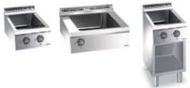
La linea è composta da modelli con riscaldamento elettrico. La vasca è a dimensioni GN 1/1 o GN 2/1, stampata, saldata al piano in modo continuo, con imbutitura perimetrale per la raccolta liquidi e d il contenimento della condensa. Capacità bacinelle Gastronorm 4/3 per moduli 40 ed 8/3 per moduli 70. Il riscaldamento è elettrico, indiretto, fissato sul fondo esterno della vasca e controllato termostaticamente.
